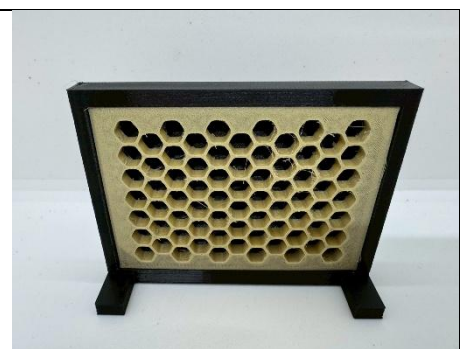
仿生蜂巢結構減速剎車
